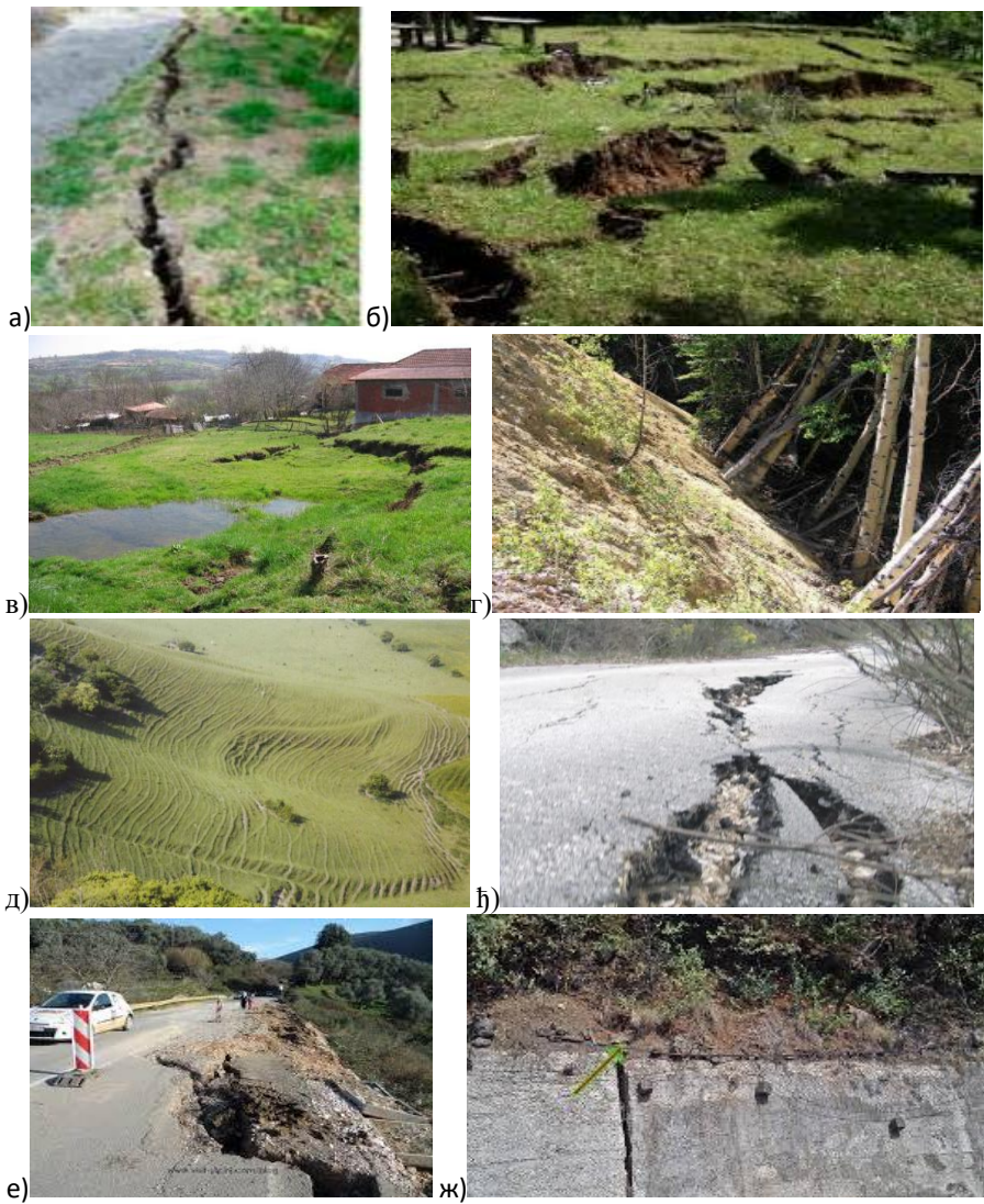
Слика 15. Знакови клизишта ван насеља: а) појава пукотине, б) ожиљака, в) забаривање тла, г) нагнуто дрвеће д) пузање (споро кретање), е) појава пукотина на путу и е) даљи развој клизишта на путу, ж) покретање ламеле потпорног зида дуж дилатационе спојнице
