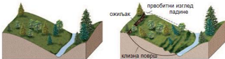
Слика 12. Клизање косине изазвано усецањем тока реке [3]
