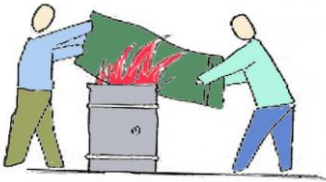
Слика 10 – Прекривање отвора мокрим ћебетом
