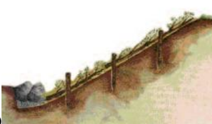
Слика 18. Хитне мере санације: а) прекривање најлоном, б) постављање хоризонталних дренова и канала (в) и г) [71], д) прерасподела маса, ђ) и е) забијање кочева
