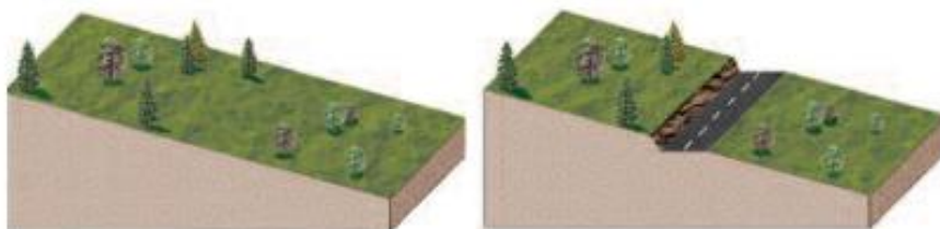
Слика 11. Клизање косине изазвано засецањем косине [3]
